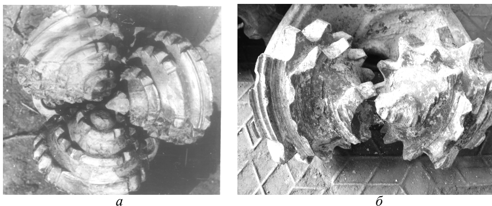
а – зношення шарошок; б – зношення шарошок з втратою однієї в забої Рисунок 1 – Характерні ознаки втрати робототності при заїданні шарошок
