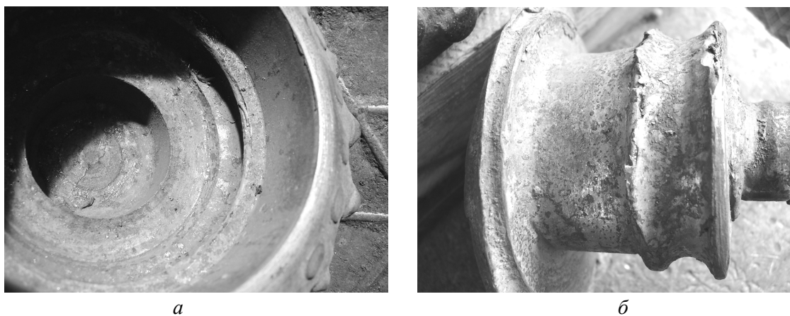
а) – зношування бігової доріжки шарошки; б) – зношування бігової доріжки на опорі
