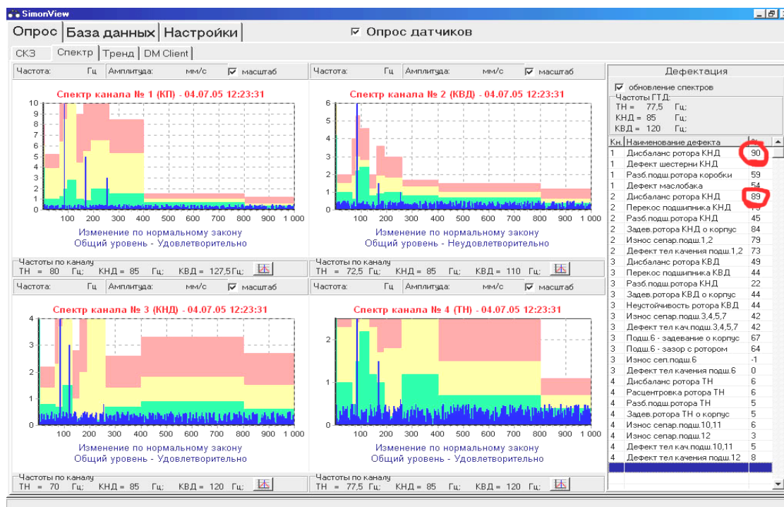
Рис. 2. Вкладка отображения спектров и результатов дефектации
