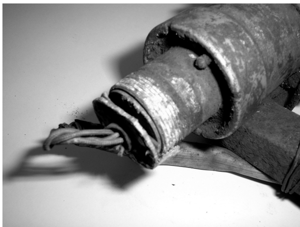
Рисунок 1 — Корозійні руйнування штатного конверсійного давача МП-95 МІВСК типу «МАК-1»
