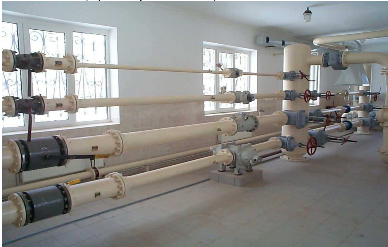
Рис. 1. Загальний вигляд установки для експериментальних досліджень лічильників на природному газі
