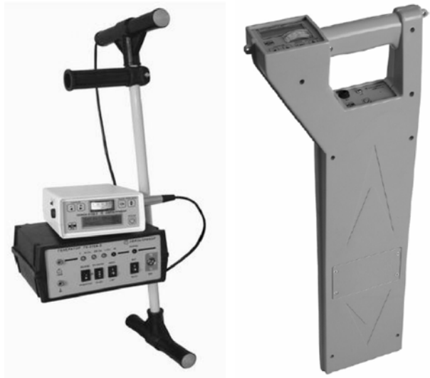
Рисунок 3 – Апаратура безконтактного контролю ізоляційного покриття «Поиск-310Д-2» і «Поиск 410» виробництва компанії «Связьприбор»
