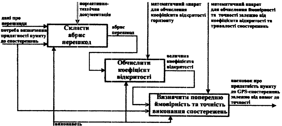
Рис. 3. Модель IDEF0 визначення придатності пункту до GPS-спостережень
