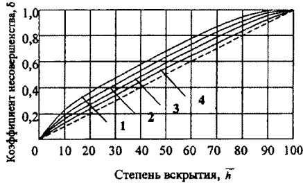
Рисунок 1 - Изменение коэффициента совершенства скважины в зависимости от степени вскрытия: 1 - h=10 м; 2 - h=20 м; 3 - h=30 м; 4 - h=40 м
