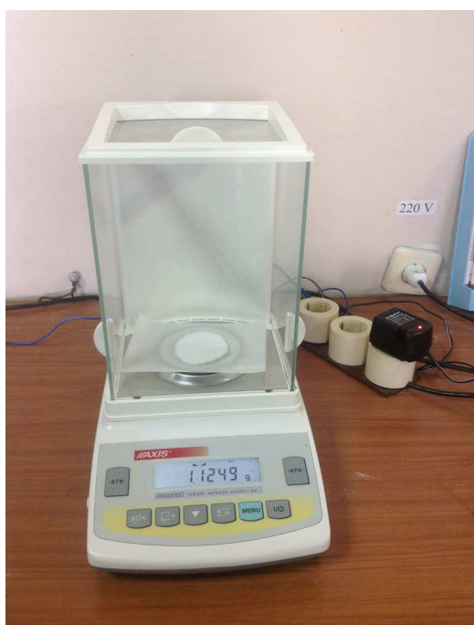
Рис. 4. Зважування чистої вати на аналітичних терезах
