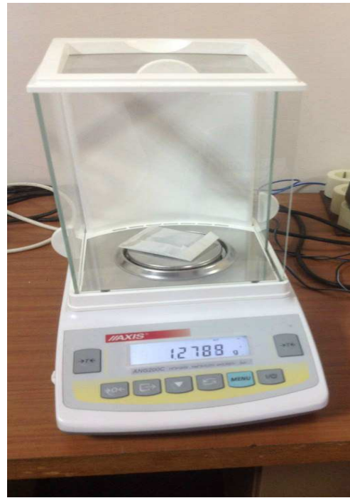
Рис. 6. Зважування вати з пилом на аналітичних терезах
