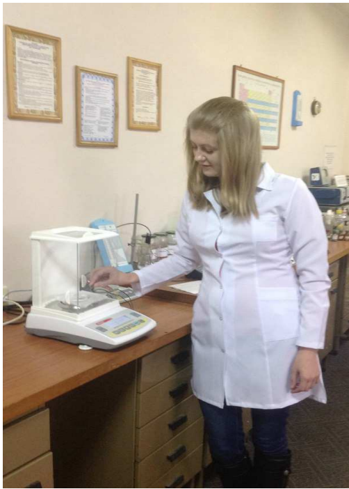
Рис. 6. Зважування вати з пилом на аналітичних терезах
