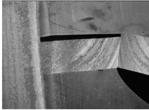
Рисунок 9 – Приклади відшарування ізоляційного покриття магістрального трубопроводу
