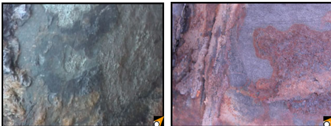
Рисунок 6 – Ділянки з локальною корозією, виявлені під час досліджень магнітометричним методом
