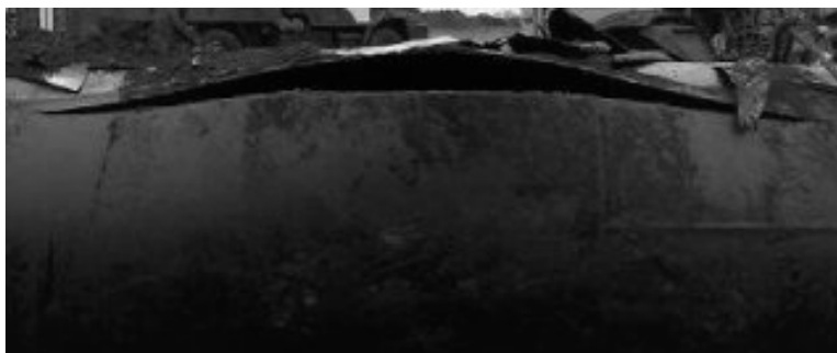
Рисунок 1 – Поздовжній розрив нафтопроводу "Дружба-1" діаметром 530 мм
