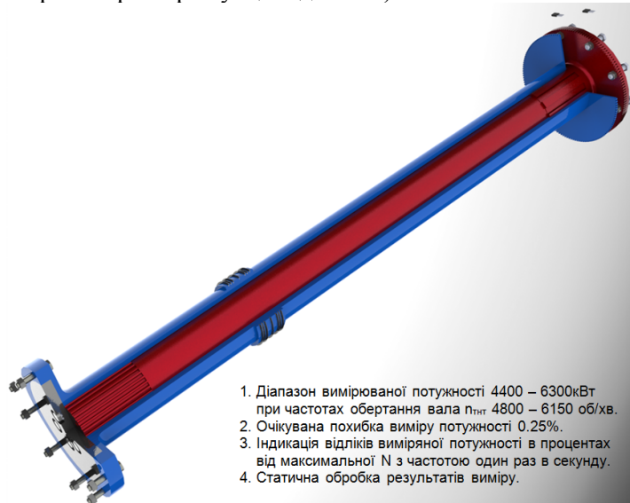
Рисунок 2 – Вимірювач потужності торсійного типу на основі мікроконтролера PIC16F84
