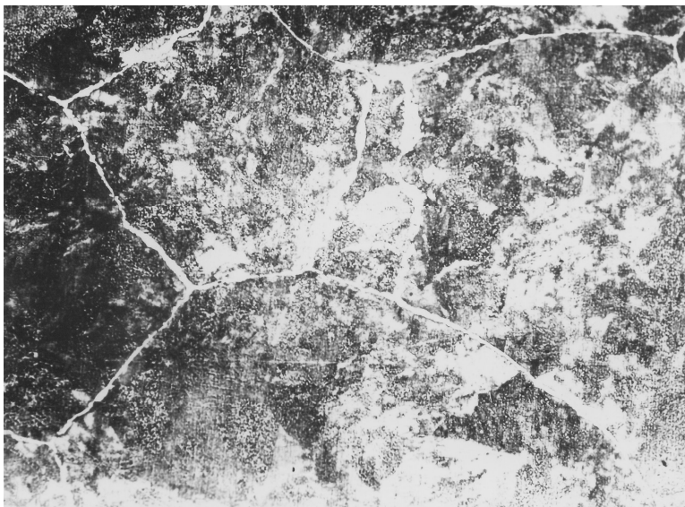
Рисунок 6 – Мікроструктура металу висадженого кінця бурильної труби
