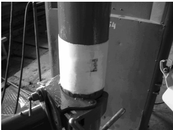
Рисунок 5 – Стан бандажу після випробувань балона з намотаним полімерно-композитним бандажем при одночасній дії згинаючих навантажень і внутрішнього тиску
