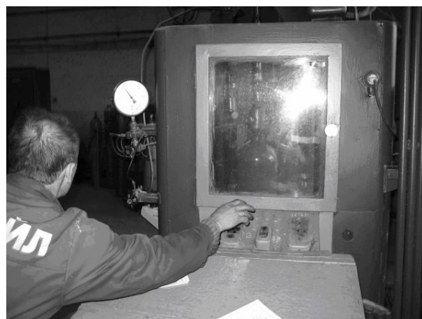
Рисунок 4 – Процес випробування балона з намотаним полімерно-композитним бандажем
