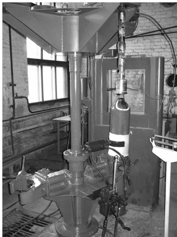
Рисунок 3 – Стенд для випробування балона з намотаним полімерно-композитним бандажем
