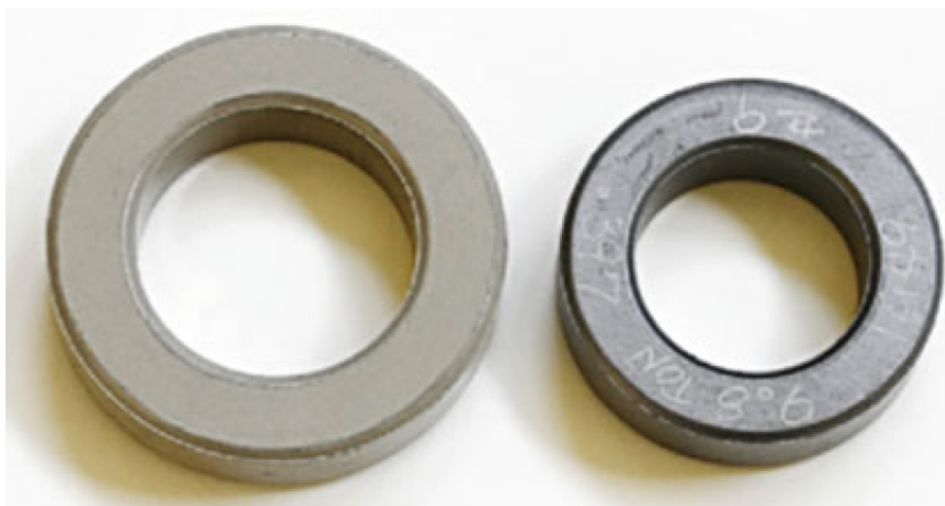
Рисунок 3 – Усадка SiC після твердофазового спікання
