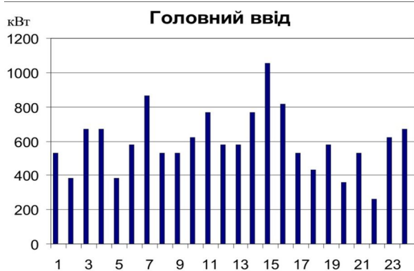
Рисунок 2 – Добовий графік активного навантаження бурового верстата
