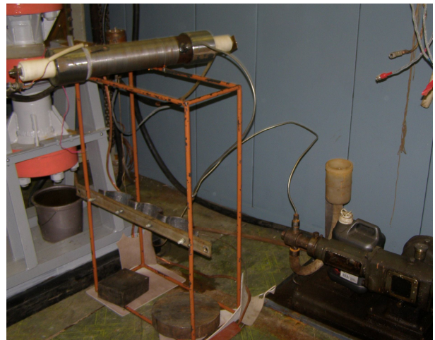
Рисунок 2 – Зовнішній вигляд стенда для випробовування матеріалів труб на втому
