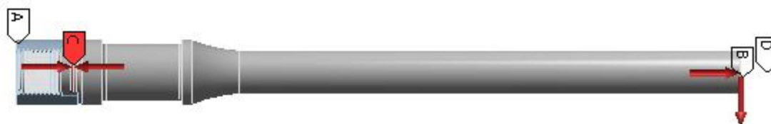
Рисунок 2 – Схема навантаження різьбового з'єднання
