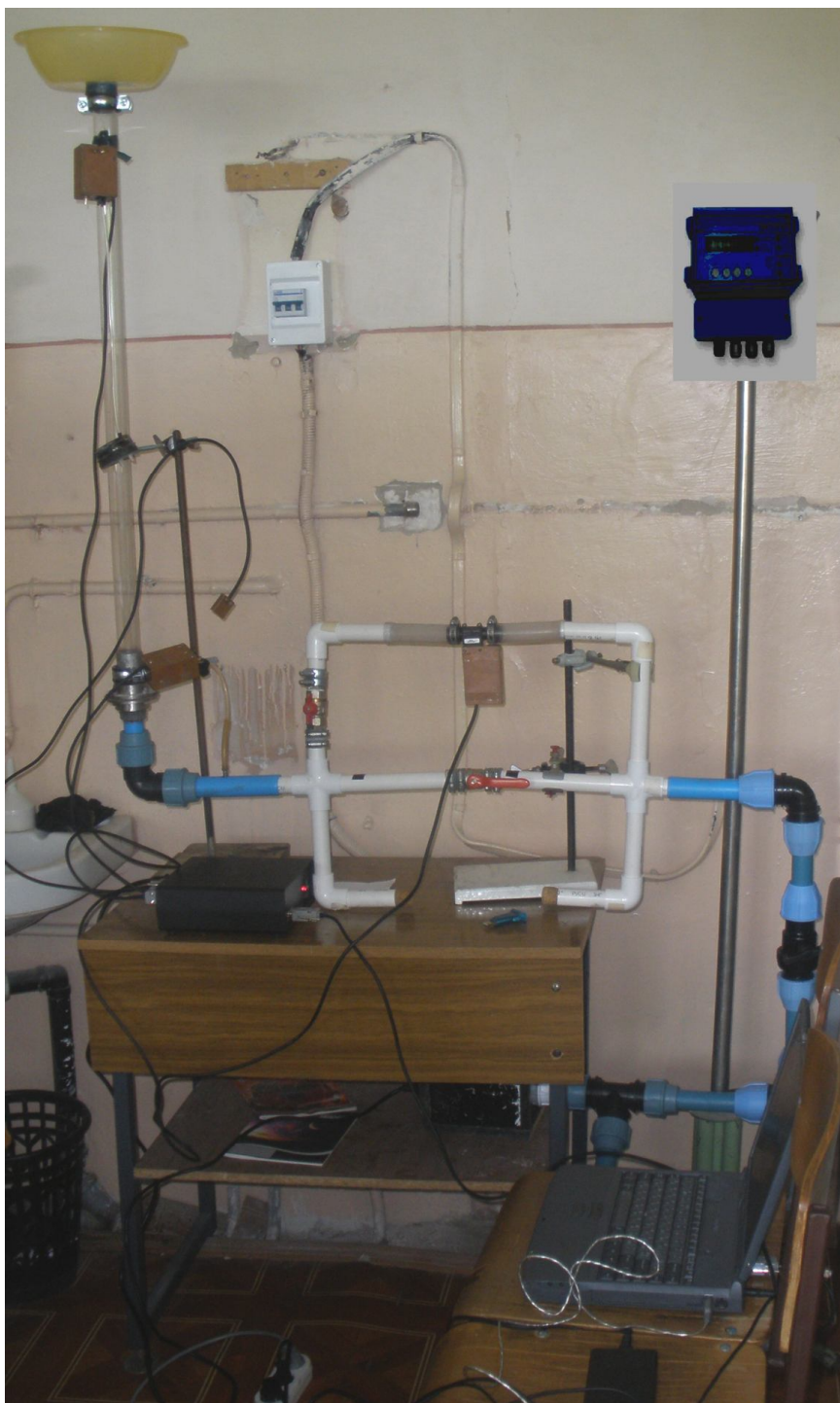
Рисунок 2 – Загальний вигляд експериментальної установки для дослідження умов винесення частинок піску із моделі свердловини
