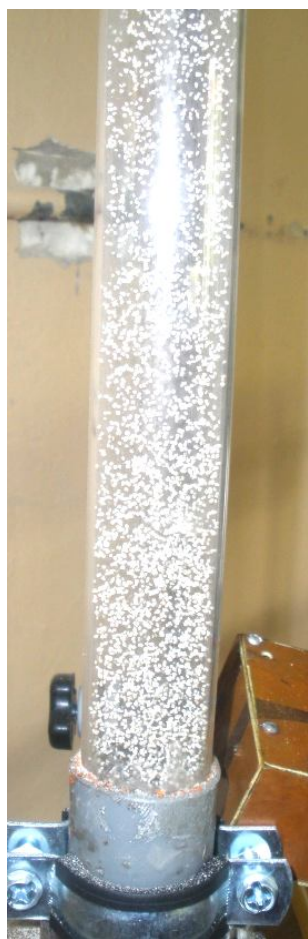
Рисунок 4 – Винесення частинок піску потоком газу у ході експерименту
