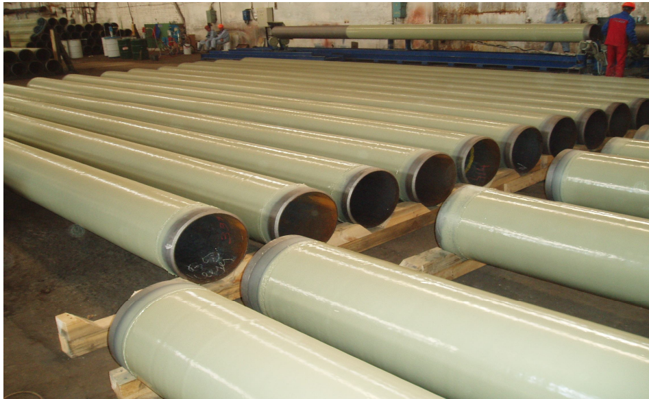
Рисунок 2 – Покриття труб поліуретаном «Байсит» у заводських умовах
