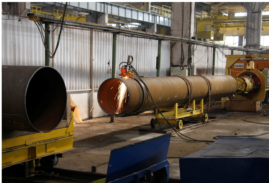
Рисунок 12 – Ремонт тіла труби на заводі
