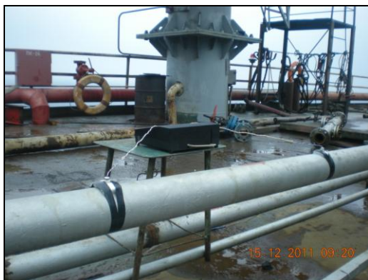
Рисунок 3 - Реєстрації інформаційних акустичних сигналів трубопроводу з газоконденсатним потоком на експериментальній установці в умовах діючого морського промислу за допомогою звукової карти комп'ютера (а) та модуля обробки інформації в режимі реального часу (б)
