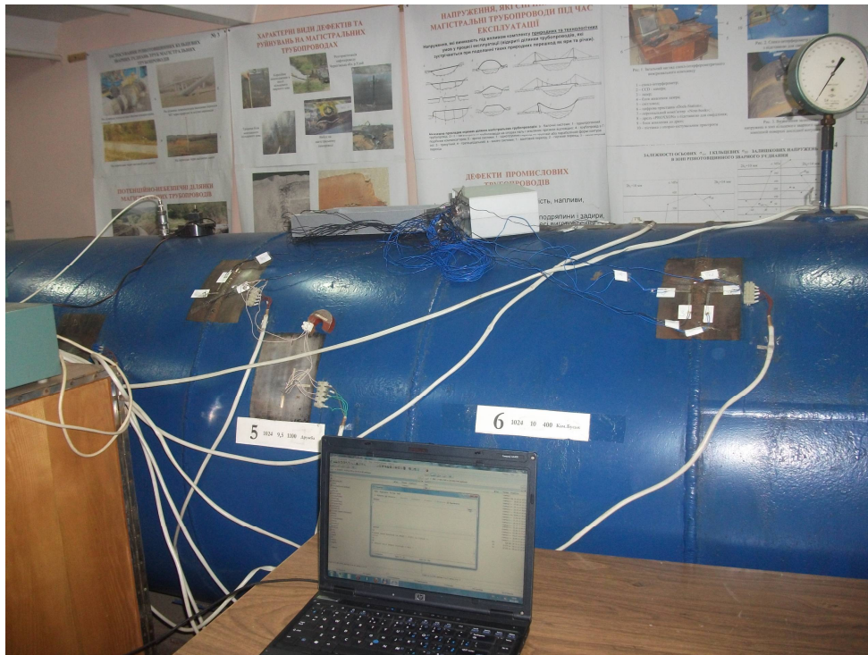
Рисунок 2 – Дослідно-вимірвальний комплекс для експериментального визначення характеристик напружено-деформованого стану в зоні основного металу і кільцевих зварних з'єднань труб МТ
