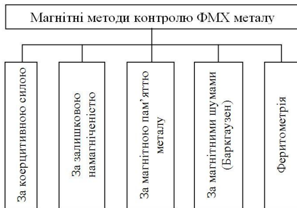
Рисунок 2 – Магнітні методи контролю ФМХ феромагнітних матеріалів
