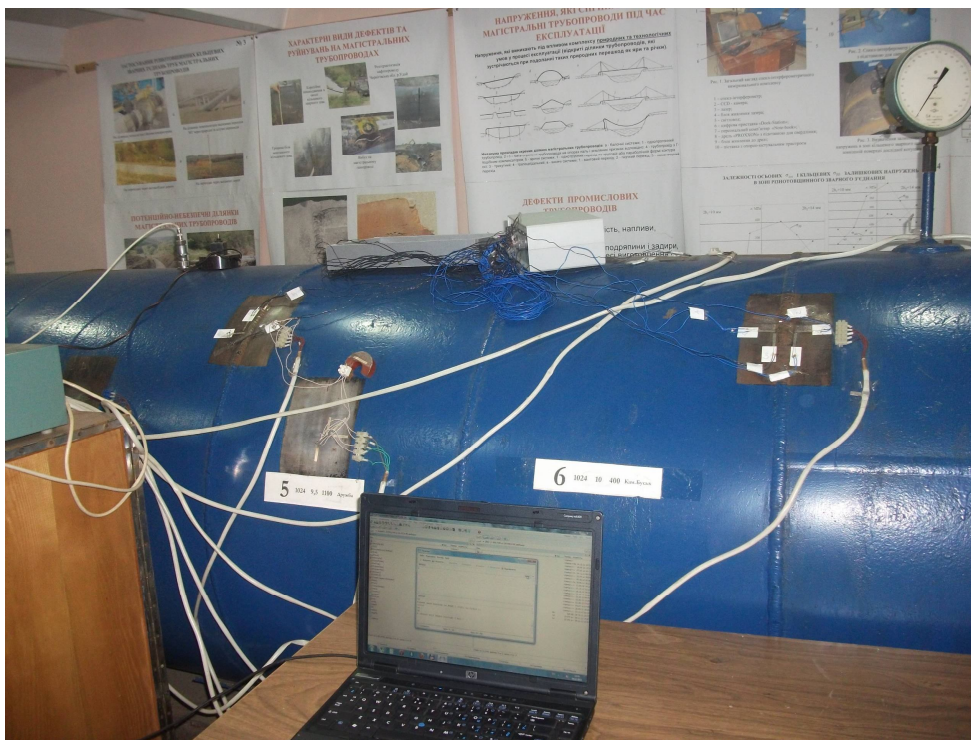
Рисунок 2 – Дослідно-вимірювальний комплекс для експериментального визначення характеристик напружено-деформованого стану в зоні основного металу і кільцевих зварних з'єднань труб МТ
