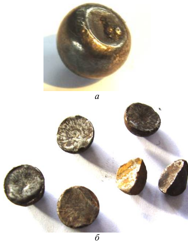
а – кулька, від якої викришився фрагмент у вигляді кульового сектора ( \times 2 ); б – кульки розколені навпіл та на чвертинки Рисунок 1 – Загальний вигляд зруйнованих кульок замкового підшипника
