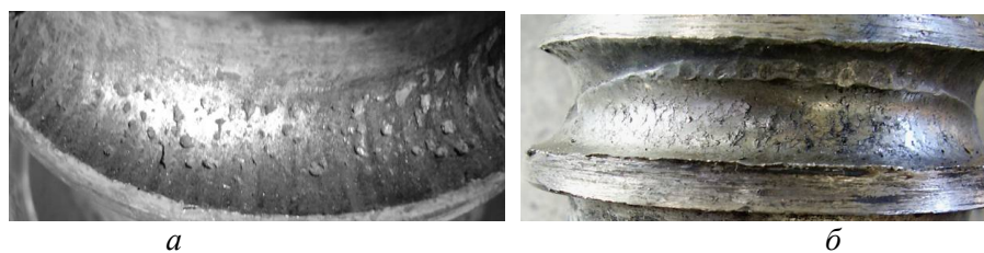
а – локальне контактне викришування поверхневих цементованих шарів на фоні загальної пластичної деформації КБД, що локалізувалося у навантаженій ділянці ближче до бурта, б – утворення другої (зміщеної) бігової доріжки на фоні загального зносу та пластичної деформації
