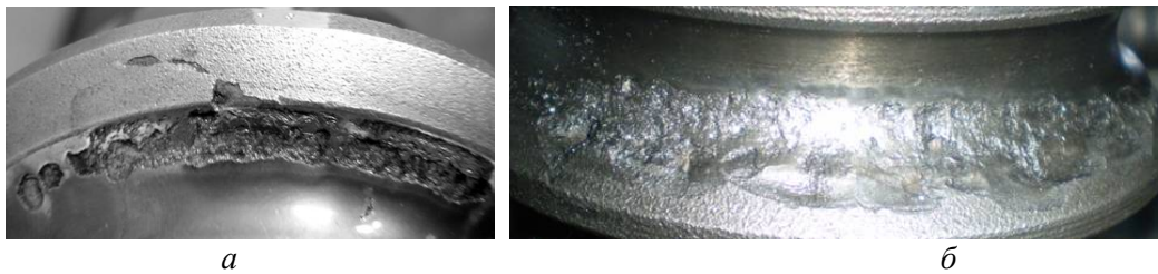
а – утворення піттингів і їх об'єднання у локальні контактні руйнування та сколювання тонких поверхневих шарів, б – об'єднання локальних контактних руйнувань з відшаруванням цементованого шару
