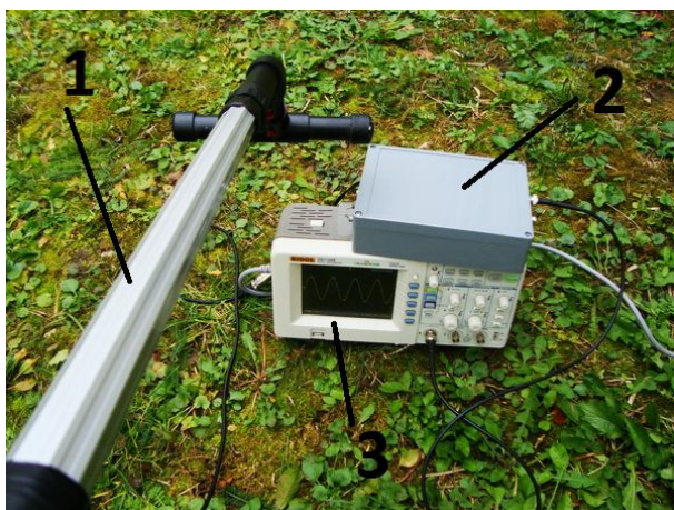
1 – магнітна антена; 2 – вимірювальний блок; 3 – цифровий двоканальний осцилограф
