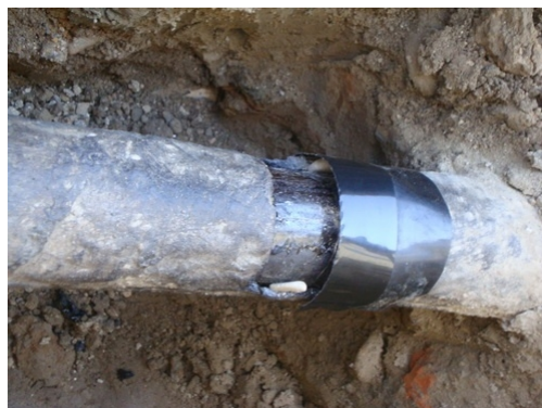
Рисунок 4 – Вигляд створеного відшарування ізоляційного покриття
