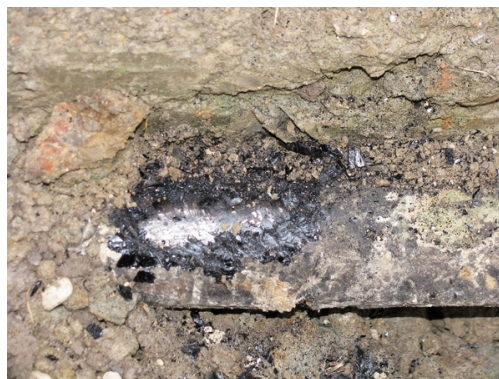
Рисунок 3 – Вигляд створеного наскрізного дефекту ізоляційного покриття
