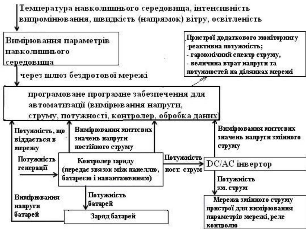
Рисунок 2 – Блок-схема типової системи сонячної моніторингу
