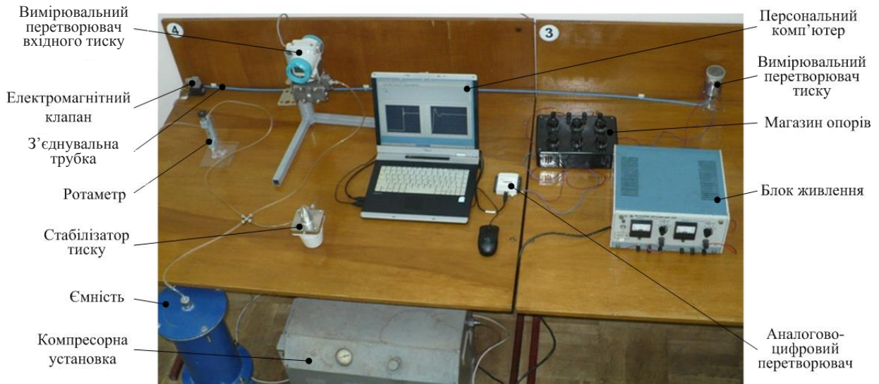
Рисунок 3 – Експериментальна установка для дослідження динамічних характеристик пневматичної лінії перетворювачів тиску
