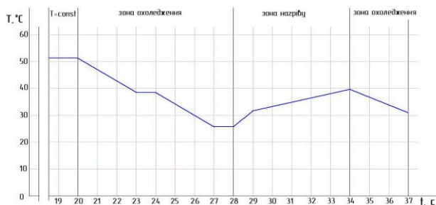
Рисунок 6 - Характер змінування максимальної температури контрольного зразка у процесі термографічної зйомки
