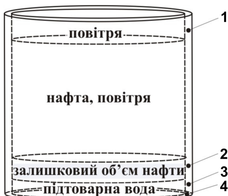
Рисунок 1 – Схема вирізання зразків з різних ділянок (1, 2, 3, 4) нафтозасховища
