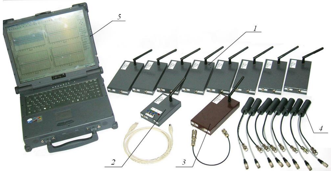
Рисунок 11 – Загальний вигляд радіотелеметричної системи акустико-емісійного моніторингу
