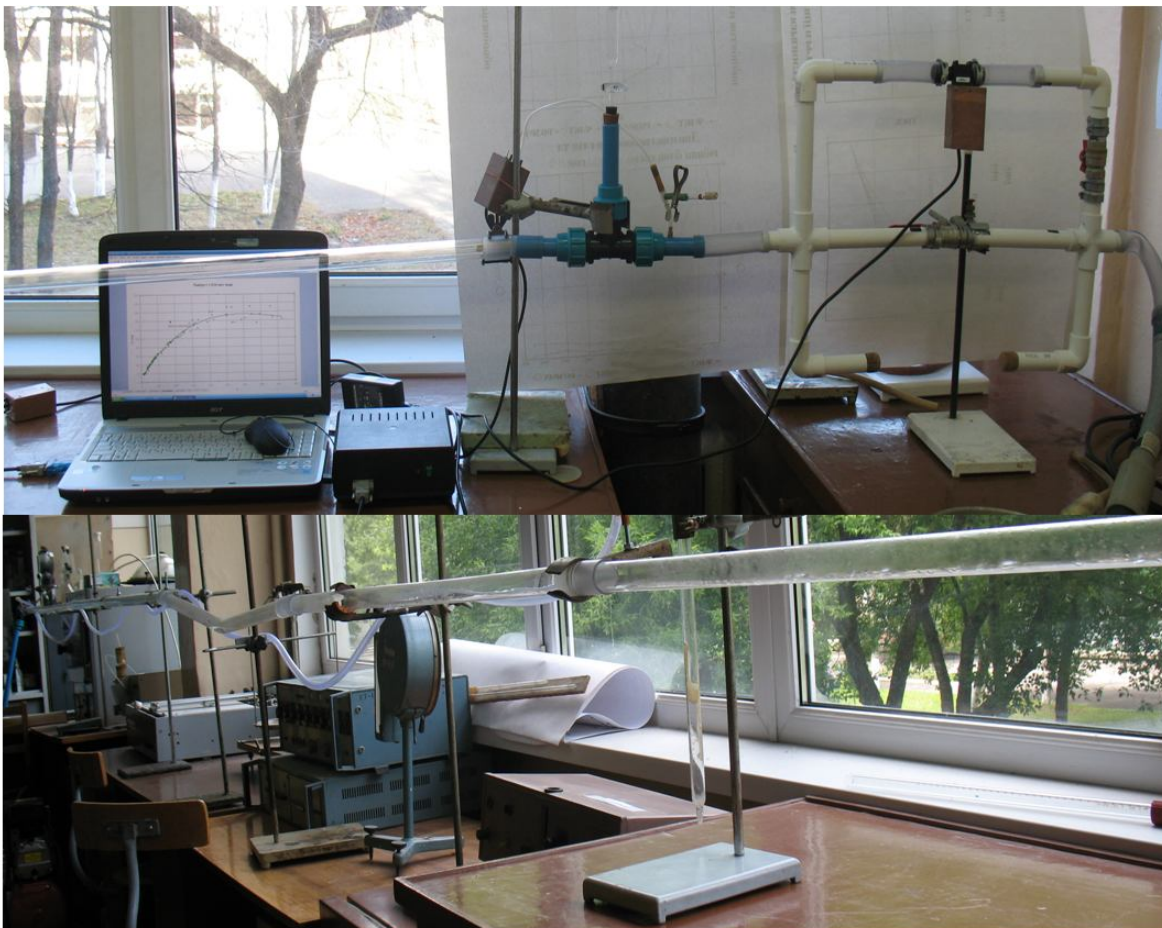
Рисунок 2 – Загальний вигляд експериментальної установки для дослідження процесу руху газорідного потоку в рельєфному трубопроводі
