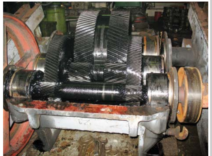
Рис. 1. Редуктор із наявністю в картері води та мастила
