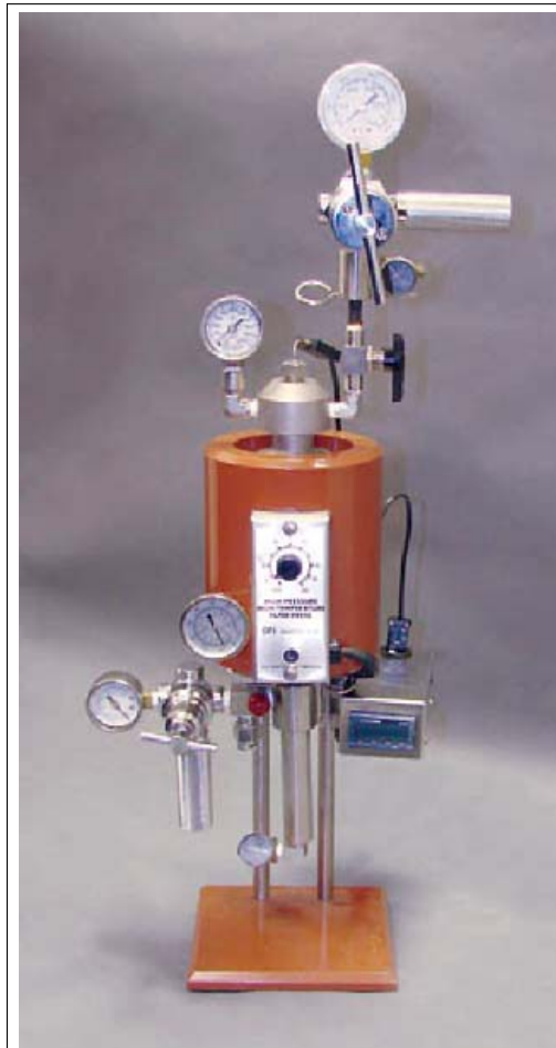
Рис. 1. Прилад для визначення показника вибівної фільтрації (tester НРНТ)
