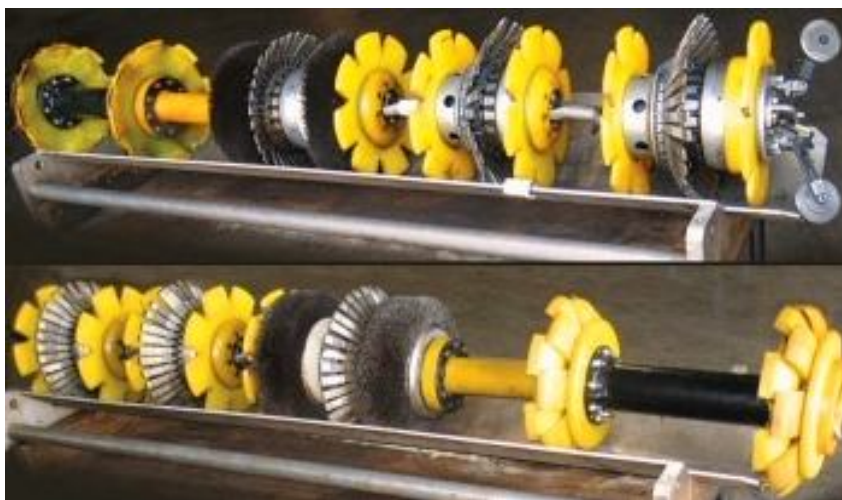
Рисунок 1 – Інтелектуальний поршень DigiTelFluxLogger фірми Enduro
