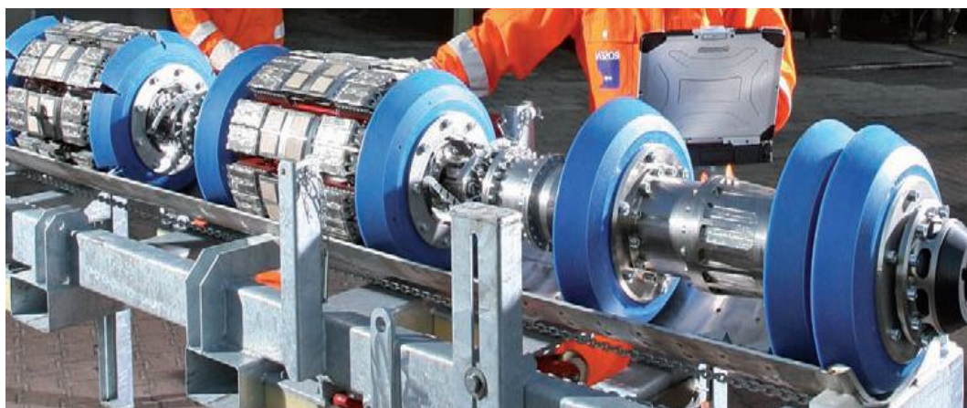
Рисунок 6 – Діагностичний пристрій RosenRoCD 2 DN 400 мм для визначення тріщин і відшарування ізоляції трубопроводу
