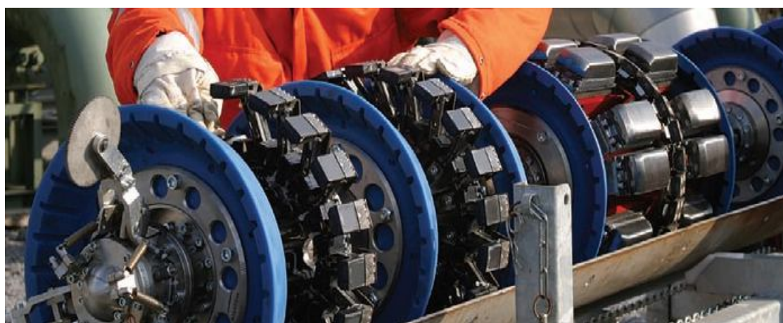
Рисунок 9 – Модульний пристрій Rosen з блоками обстеження втрат металу, дослідження геометрії і визначення просторового положення трубопроводу
