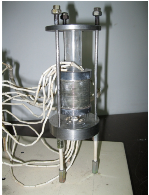
Рисунок 2 – Загальний вигляд комірки для вимірювання термоелектричних параметрів
