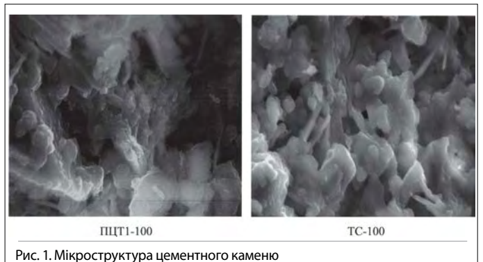
Рис. 1. Мікроструктура цементного каменю
