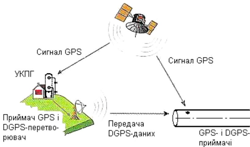
Рисунок 2 – Метод диференційованої корекції DGPS
