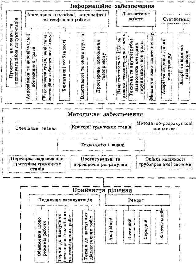
Рис. 1 - Загальна схема стратегії прогнозування міцності та довговічності лінійної частини магістральних газопроводів
