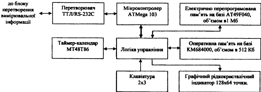
Рис.8. Структурна схема контролера збору інформації К-103
