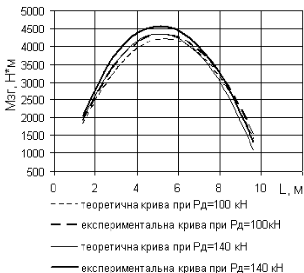
Рисунок 5 – Залежність згинального моменту по довжині КНБК, при zenітному куті 10°
