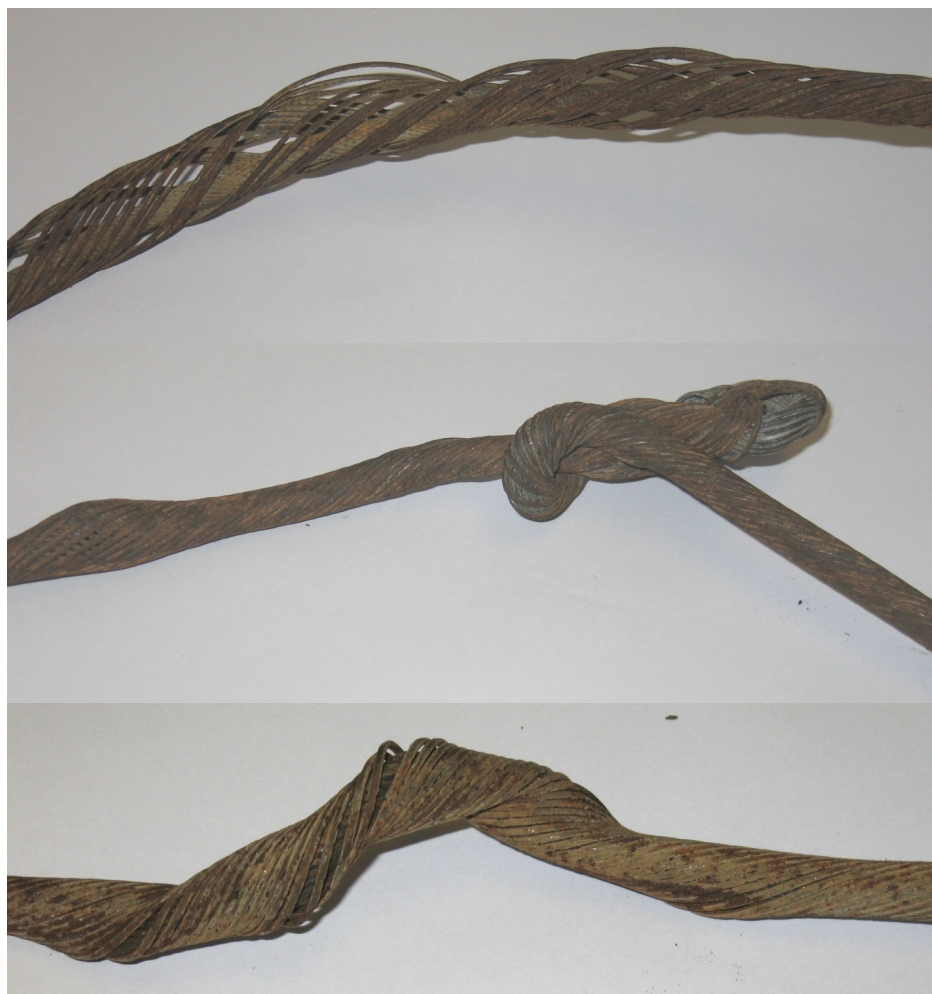
Рисунок 1 – Приклади дефектів кабеля
