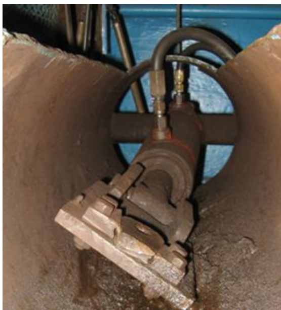
а) затискач; б) навантажувальний вузол (гідроциліндр); в) електронасос НЕЕ-0,8 I 10 Ф1
