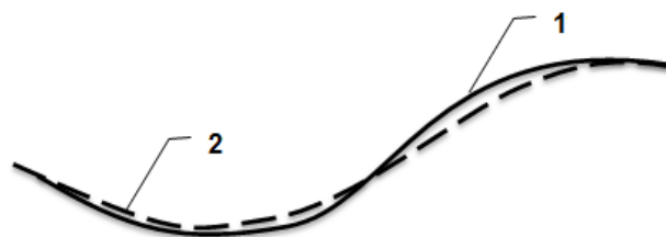
Рисунок 2 – Проекції траєкторій колони насосно-компресорних труб (1) та штангової колони (2)
