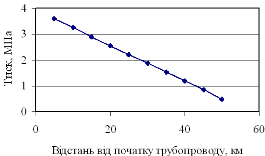
Рисунок 3 – Розподіл тисків вздовж трубопроводу
