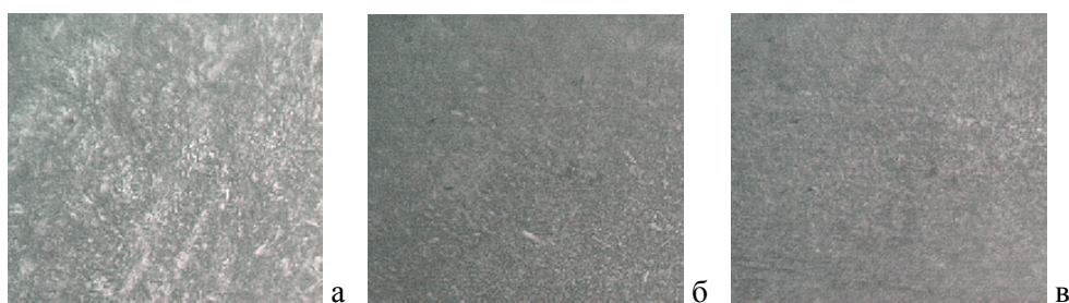
а – серцевина; б – перехідна зона; в – цементований шар
