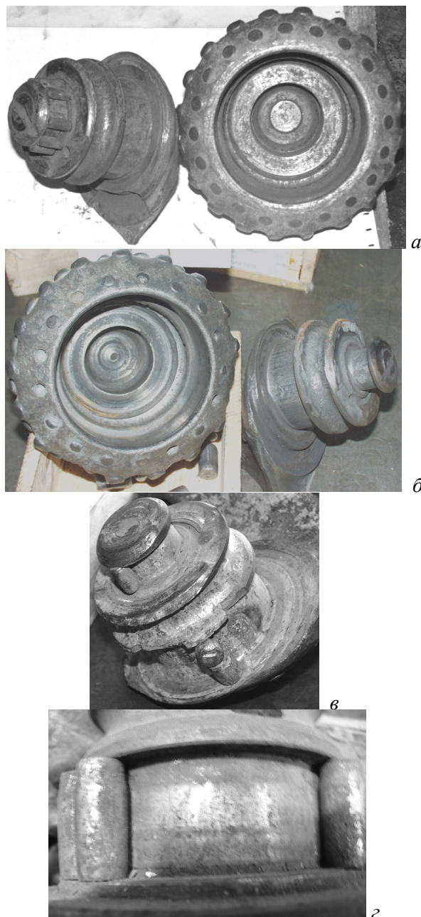
а – проходка 40 м; б – проходка 51 м; в – проходка 82 м; г – завальцювання роликів, які набули бочкоподібної форми
