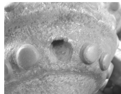
Рисунок 4 – Випадання зубка з шарошки, виготовленої із сталі 20ХНЗМА за недостатнього натягу під час посадки
