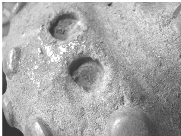
Рисунок 1 – Випадання твердосплавних зубків, спричинене гідроабразивним та ударноабразивним зношуванням матеріалу вінців шарошки
