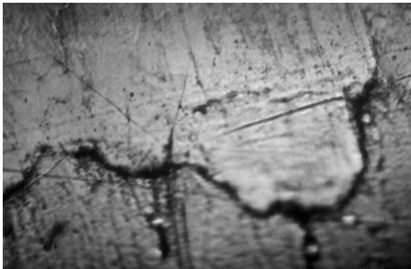
Рисунок 5 – Характерні дефекти хромового покриття штока після фінішної обробки, \times 30 р.
