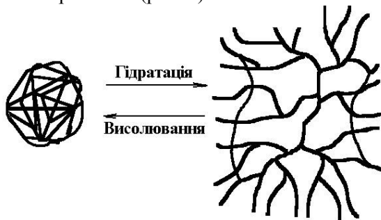
Рисунок 3 — Механізм гідратації і дегідратації ланцюгів молекул біополімеру
